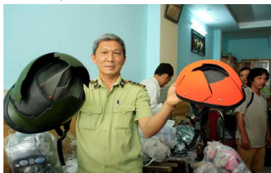
Những loại MBH không đạt chất lượng dễ dàng vỡ vụn chỉ với lực va đập nhẹ
